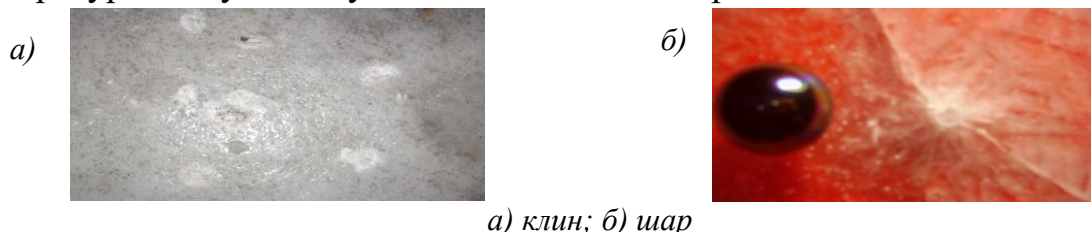
Рисунок 7 – Следы от внедрения в лёд клина и шара
